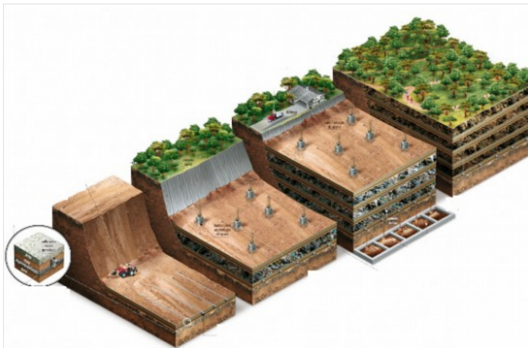
Figura 3 - Esquema da evolução da construção de um aterro em uma depressão.
